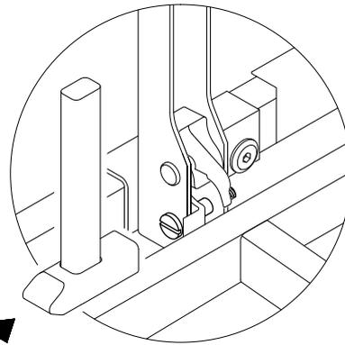
5.1 Гайки затянуть после того как все винты (M6x28x9) установлены.
